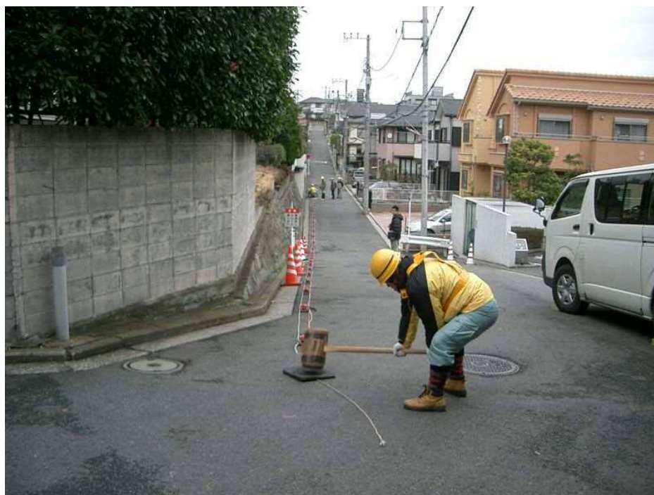
図参 3.2-⑤ 表面波探査試験の実施風景
