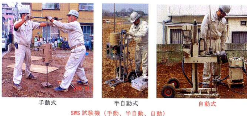
図参 6.4-③ スウェーデン式サウンディング試験位置と概要図
