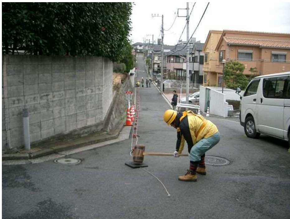
図参 6.4-⑤ 表面波探査試験の実施風景
