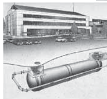
耐震性貯水槽
