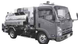
▲加圧式給水車。高さ20mの高所に給水が可能
