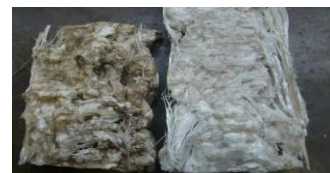
左が塩竈市から出た発泡スチロールのリサイクル原料。汚れたものが多い、品質に悪影響を与えています。
