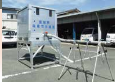
給水ポイントに設置される仮設水槽▶
