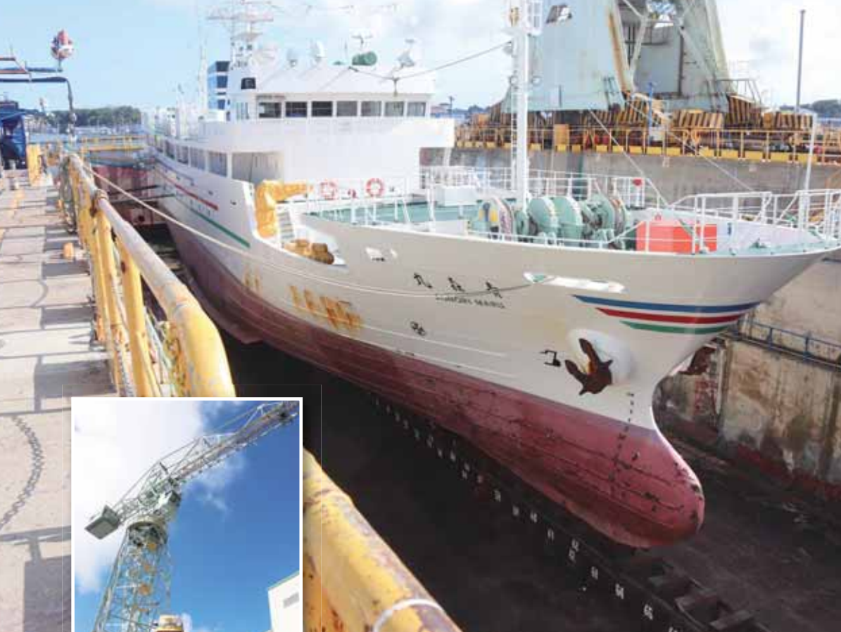
▲昭和18年に作られた海水を抜いて船体を修理できる乾ドック(1号ドック) 写真は現在の様子 ◀千葉さんと高さ約35メートルの2号クレーン。工場内には同型の3号クレーンがあり、いずれも昭和18年に設置され、78年間稼働し続けている
