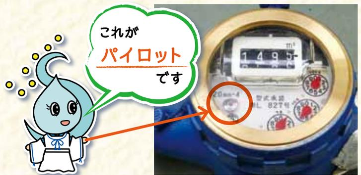
メーター内のパイロットを確認してください。文字盤の中にある銀色で八角形のもの、もしくは赤い花のような形のものが、パイロットです。パイロットが回っているようであれば、漏水があることとなります。
